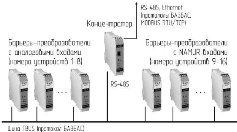
Рис. 3.2. Структурная схема взаимодействия Концентратора и Барьеров-преобразователей (с цифровыми интерфейсами)
